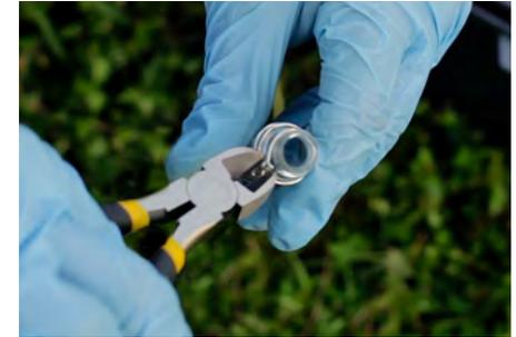
**4** Corte TODO el alambre del Muestreador usando cortadores de alambre, y limpie completamente las roscas del vial con la tela de gaza.
