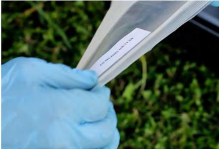
**9** Selle la Bolsa de Envío de Retorno y colóquela en la bandeja superior del Kit de Campo, y coloque las herramientas y materiales suministrados debajo de la bandeja, en el compartimento inferior (bloques, muestreadores adicionales, herramientas, etc.).
