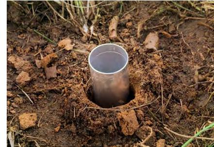
**3** Inserte el tubo en el agujero y empuje o golpee suavemente el tubo 1.25 cm por debajo de la superficie de suelo usando el taco golpeador y un martillo. Si es necesario, primero corte el tubo para que esté al ras, o justo por debajo, de la superficie de suelo antes de golpear suavemente el tubo en el agujero.
