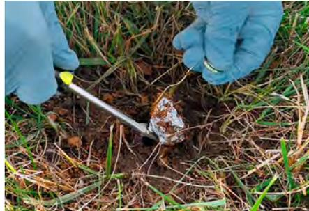
**2** Limpie el suelo y gentilmente remueva el taco de papel aluminio usando un pequeño desatornillador, de ser necesario. Retire el Muestreador del agujero jalando gentilmente el alambre .
