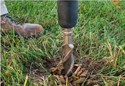
**1** Use un rotomartillo y brocas de taladro para crear la vía de vapor de suelo. Perfere un agujero de 3-4 cm de diámetro a una profundidad de aprox. 30-35 cm. Usando una broca de taladro de 1.25-2 cm, perfere un agujero a una profundidad 90 cm.
