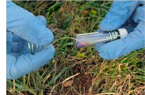
**4** Retire un Muestreador Beacon y desenrolle el alambre de retiro enrollado alrededor del mismo, formando un pequeña bobina de alambre en el extremo. Extienda el alambre de manera que el Muestreador se introduzca fácilmente en el tubo.
