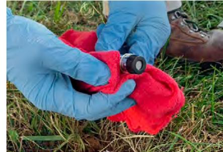
**3** Limpie los costados del Muestreador con la toalla y remueva la Tapa Negra de Muestreo. No retorne la Tapas de Muestreo usadas.
