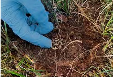
**9** Cubra el agujero hasta el nivel de superficie con suelo local o arena, dejando el extremo del alambre expuesto por encima de la superficie del suelo. Use un martillo para apelmazar/compactar el suelo por encima del muestreador. Forme una bobina con el alambre y colóquelo en posición plana en la superficie del suelo.
